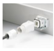
Die 4-adrige Rundleitung ist dank Schneid-Klemm-Technik in wenigen Sekunden angeschlossen: Es muss nur noch die Überwurfmutter auf die Leitung geschoben werden, denn der Spleißring, die Dichtung und die Zugentlastung sind in der Überwurfmutter enthalten.
