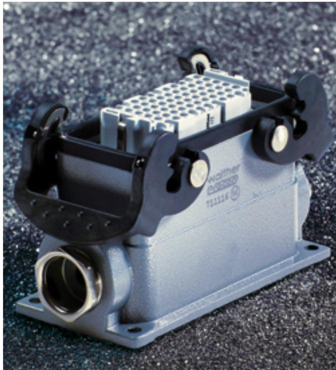
Die Bestückung der Kontaktträger der Baureihe DD ist ausschließlich mit Crimpkontakten möglich. Diese sind separat je nach verwendetem Leitungsquerschnitt zu bestellen und werden mit einer Crimpzange vercrimpt. Die Kontakte werden dann mit Hilfe des Montagewerkzeugs in den Kontaktträger eingerastet und mit dem Demontagewerkzeug bei Bedarf wieder gelöst.
