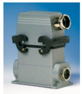
Einfaches, kostensparendes Austauschen von Längs- oder Querverriegelungsbügeln im Schadens- oder Ermüdungsfall. Ersatzbügel einfach in axialer Richtung bis zur Verrastung auf die Bolzen aufdrücken.
