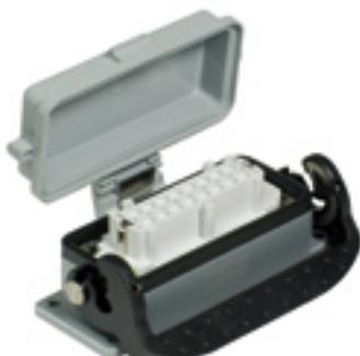
Schraubkontakteinsätze sind sowohl mit als auch ohne Drahtschutzplättchen erhältlich. Der Drahtschutz erspart die zeitaufwendige Montage der Aderendhülsen. Alle Walther-Kontakte haben selbstverständlich offene und unverlierbare Schrauben.
